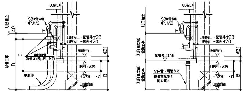
※印寸法: 引戸の場合は図面表示寸法より8mm高くなります。
