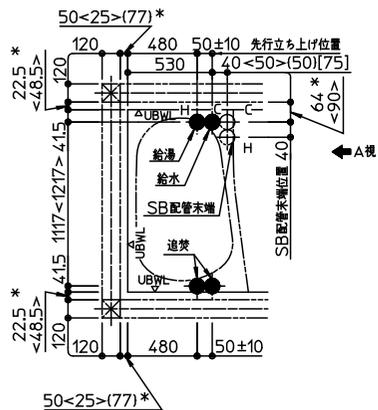
給水・給湯管は、基本仕様で壁裏配管となります。
